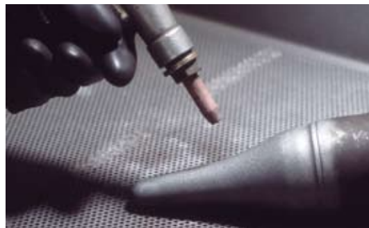
Figura 15 Suflare pentru a curate suprafata
