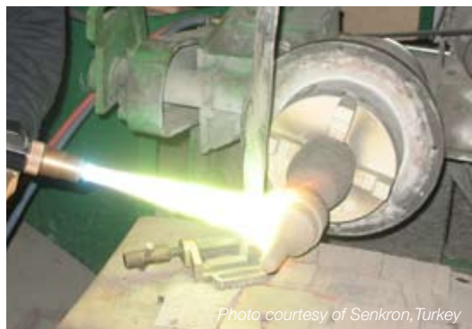
Figura 21 condiții corecte de sprayere
