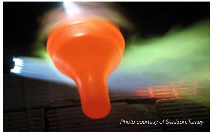
Figura 25 Terminarea fuziunii plonjorului
