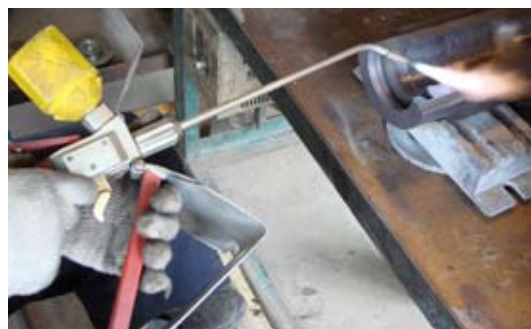
Figura 16 sudura cu pulbere a marginii matritei
